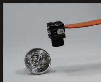
写真：ヘッド分離で小型化 VGA@480fps
