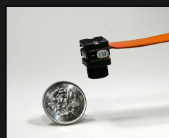
写真: ヘッド分離で小型化 VGA@480fps
